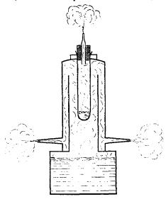
Dann wurde der Stopfen gelüftet, und der dabei hörbare Ton mit der Violine bestimmt. Da der Ton der mit Luft gefüllten Röhre bei der Zimmertemperatur t bestimmt wurde, der Ton des Dampfes dagegen bei  $100^{\circ}$ , so gestaltet sich die Formel zur Berechnung der Dampfdichte  $d = \left(\frac{N}{n}\right)^2$  [1 + (100 - t) 0.00366].
